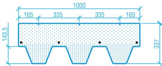
Для монтажа кровельного покрытия СМАЛЬТО необходимо ровное, сухое и чистое основание, которое может быть выполнено из ОСП (ориентированно-стружечной плиты), фанеры повышенной влагостойкости, шпунтованной, обрезной доски, железобетонных плит и т.д. Стыки элементов основания следует располагать вразбежку с зазором 3–4 мм, при этом перепады по высоте не должны превышать 2 мм.
